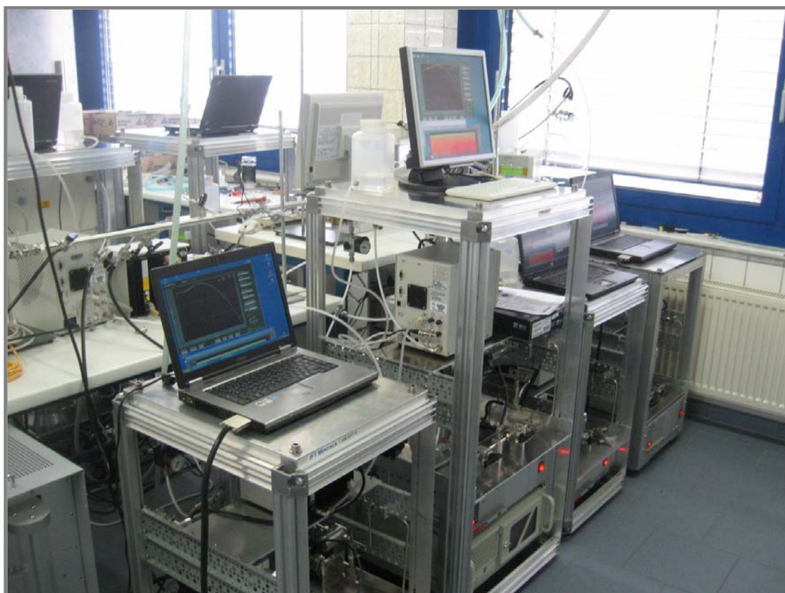
Figure 1: Comparison of different mobility particle size spectrometer at the IFT (Intercomparison workshop 2011)/ Slika 2: Primerjava različnih spektrometrov za določanje številčne porazdelitve delcev, glede na velikost, na IFT (2011).
